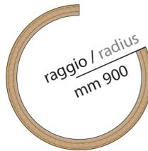
Test di flessibilità: raggio di curvatura non al di sotto di mm 900.
